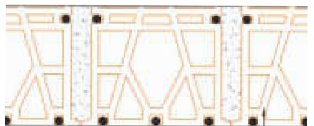
Sezione Solai tipo «SAP»
